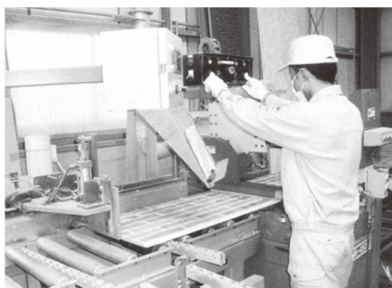
工場での外壁プレカット
