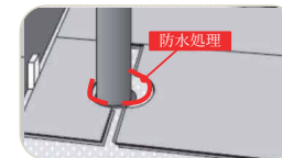
フロアをはめ込んだら、木口に 防水処理を施します。
