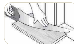
建具枠等を手鋸でカットします。
