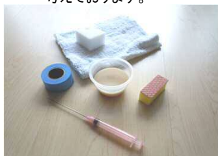
用意するもの： 床鳴り防止材 マスキングテープ 注入器(スポンジ等でも可)・雑巾
