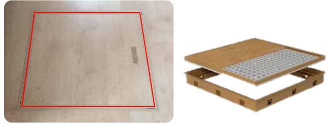
■点検口の蓋は、既存のフロアを剥がし、『4mmベニヤ + 4mmベニヤ + LVTフロア』『2.5mmベニヤ + LVTフロア + LVTフロア』など、厚みを合わせて施工してください。
