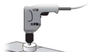
配管口径よりも大きめに穴を開けます。
