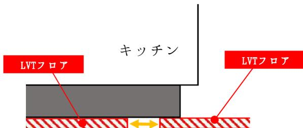
あらかじめLVTフロアを施工し、「下駄」を履かせることで、キッチン下にクリアランスを確保します。
