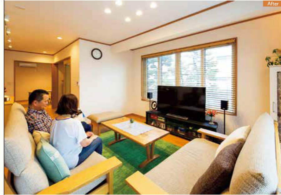
2間続きの和室をフローリングにして、東南側はリビングに。窓をペアガラスにしたことで、断熱性に加え遮音性も格段に向上。窓の外が4車線の大通りとは思えないほどの静けさだ
